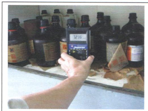
Gambar 3. Hasil pengukuran laju paparan radiasi dalam *Fume Hood* pada Fasilitas Preparasi Sumber Terbuka
