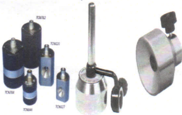
Gambar 2. Berbagai bentuk kolimator pada peralatan radiografi gamma
