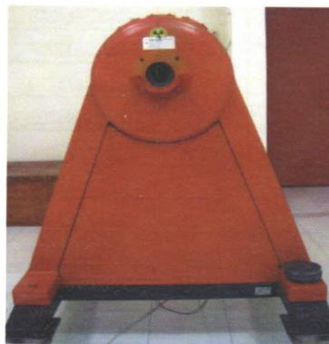
Gambar 2. Kontainer sumber Cs-137 untuk penyinaran dosimeter OSL
