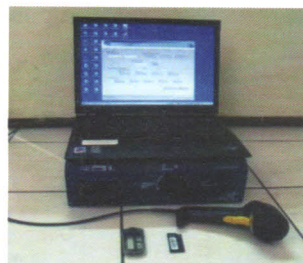
Gambar 1. Lencana dosimeter OSL dan Microstar OSLD Portable Reader yang tidak dilengkapi perangkat annealing
