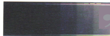
Gambar 3 : Film stepwedge untuk pengukuran keeerahan eahaya
