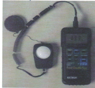
Gambar 2 Luxmeter EXTECH Model 409026 untuk mengukur keeerahan eahaya
