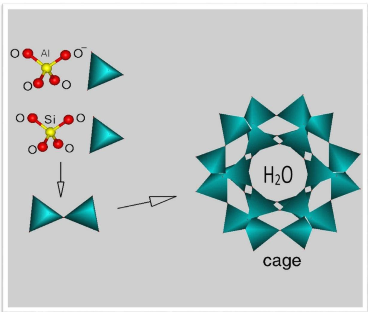
*Kerangka Struktur Zeolit pada Unit Tetrahedral*
