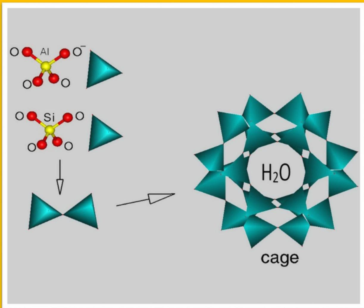
*Kerangka Struktur Zeolit pada Unit Tetrahedral*
