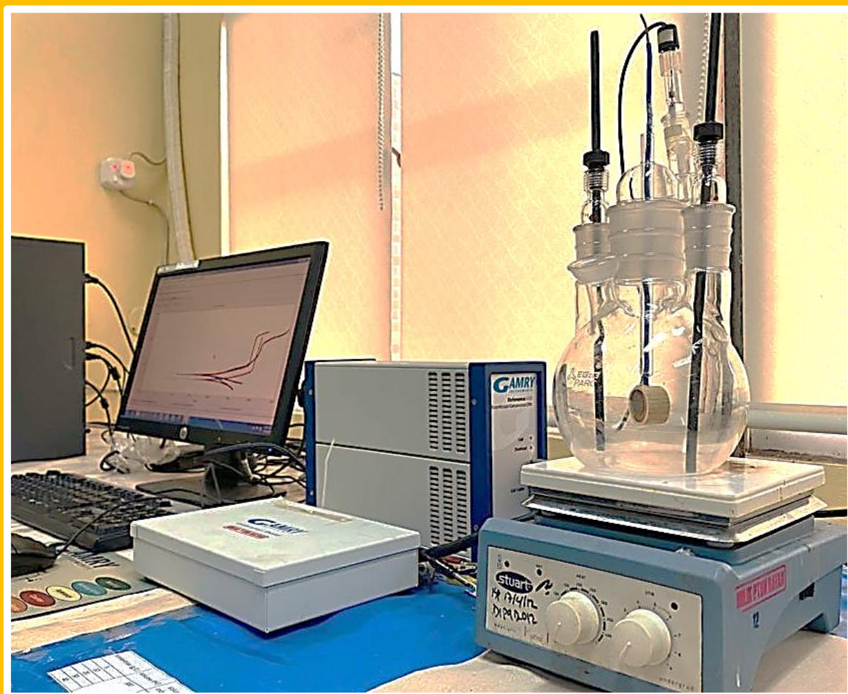
Potensiostat – Uji Korosi Metode Polarisasi
