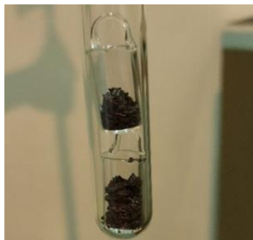
Gambar 4. Hasil hidriding paduan uranium.
