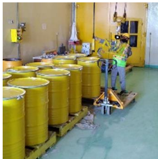
Gambar 2. Drum baja karbon 200 Lt wadah limbah radioaktif
