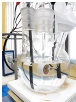
Gambar 1. Pengujian elektrokimia spesimen Zr-2
