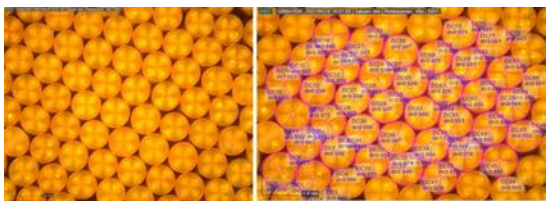
Gambar 10. Visual gel kering dari prekursor zirkonium oksinitrat dengan metode prenetralisasi dekomposisi urea.
