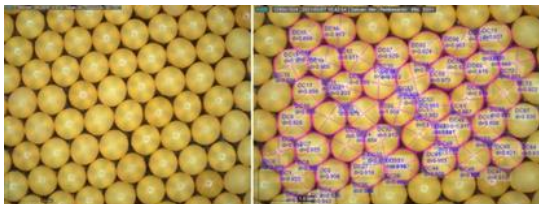
Gambar 9. Visual gel kering dari prekursor zirkonium oksinitrat dengan metode prenetralisasi presipitasi-redispersi.
