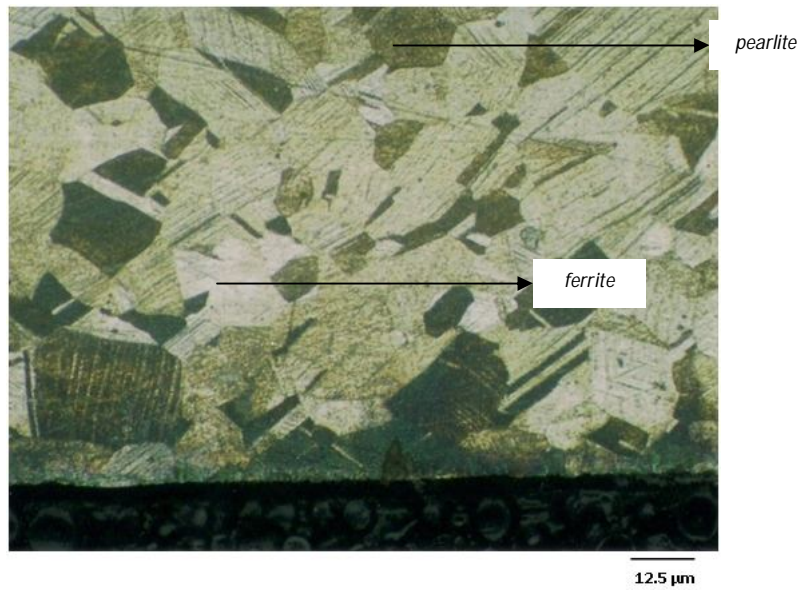
Gambar 4. Struktur mikro Stainless Steel 316L dengan perlakuan RF-Plasma Nitrocarburizing pada waktu 3 jam dan temperatur penahanan 400 °C perbesaran 200X.
