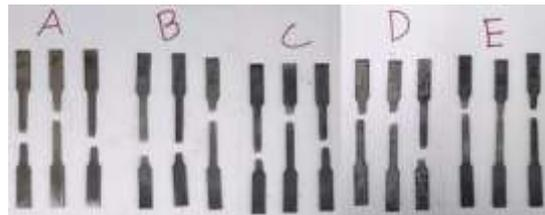
Gambar 3. Sampel setelah dilakukan uji tarik.
