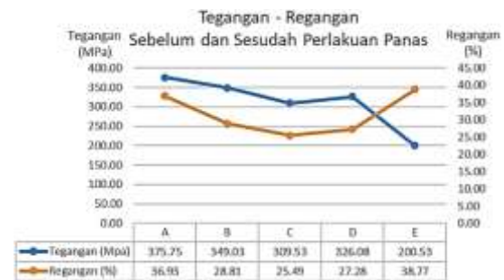
Gambar 4. Grafik tegangan-regangan sebelum dan setelah dilakukan perlakuan panas.
