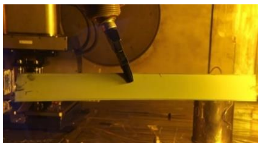
Gambar 5. Visualisasi PEB U_3Si_2/Al densitas 4,8 gU/cm 3 dengan burn up 60%.
