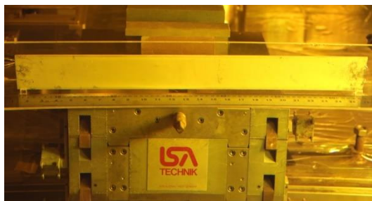
Gambar 4. Visualisasi PEB U_3Si_2/Al densitas 4,8 gU/cm 3 dengan burn up 40%.
