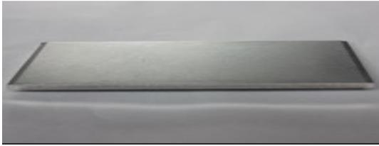
Gambar 8. Contoh IEB U-7Mo-1Si /Al hasil pengepresan.
