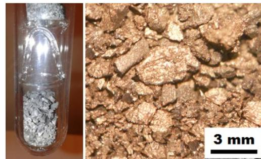
Gambar 7. Paduan U-7Mo-xSi hasil proses hidriding-dehidriding
