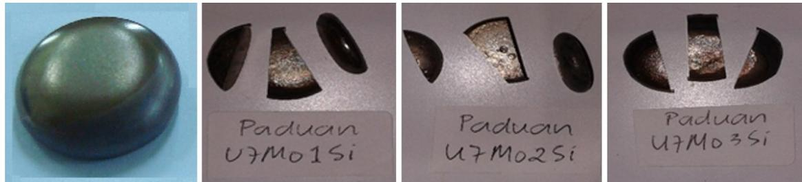
Gambar 4. Ingot paduan U-7Mo-xSi hasil proses peleburan dan potongannya
