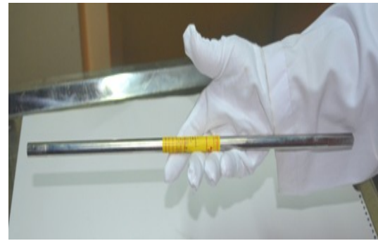
Gambar 2. Pin elemen bakar uji tipe PWR
