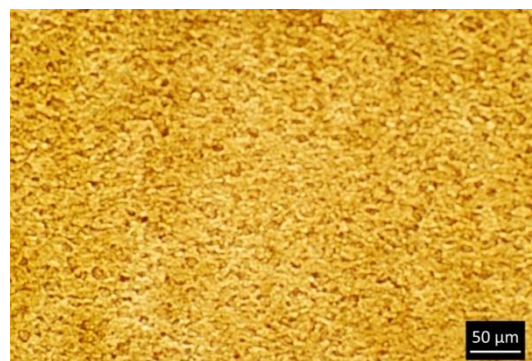
Gambar 2. Mikrostruktur Zr-4 tanpa perlakuan pada perbesaran 200x
