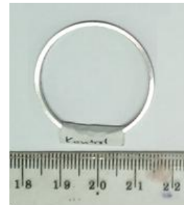
Gambar 2. Sampel SS304 berbentuk cincin
