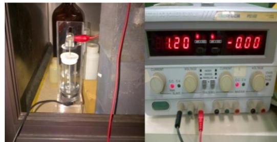
Gambar 2. Rangkaian sel elektrodeposisi dan *power supply*
