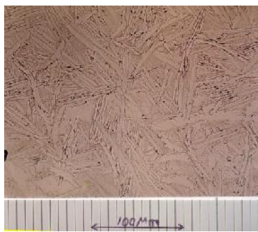
Gambar 3. ELS 1.0 w% Fe, quenching , 400x.
