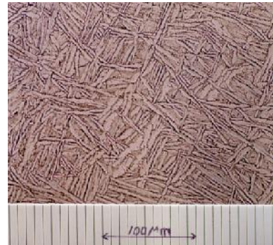
Gambar 2. ELS 1.0 w% Fe, quenching , 400x.
