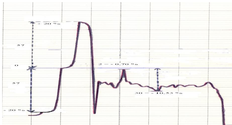
Gambar 6. Hasil Uji Homogenitas PEB. U_3O_8 -Al dengan Radiografi Sinar-X
