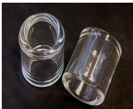
Gambar 2: Gelas Raschig –Ring Sebagai Penyerap Neutron
