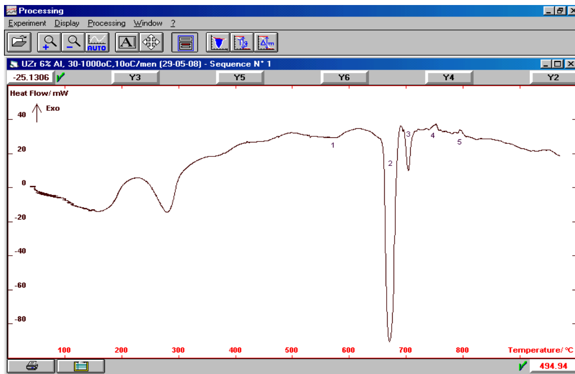
Gambar 9 .Termogram DTA interaksi paduan U-6Zr-Al Kurva temperatur terhadap aliran panas
