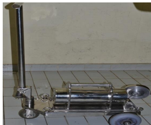
Gambar 14. Prototipe container stainless steel sumber radiasi gamma isotop 137 Cs terbuat dari stainless steel dan shielding Pb
