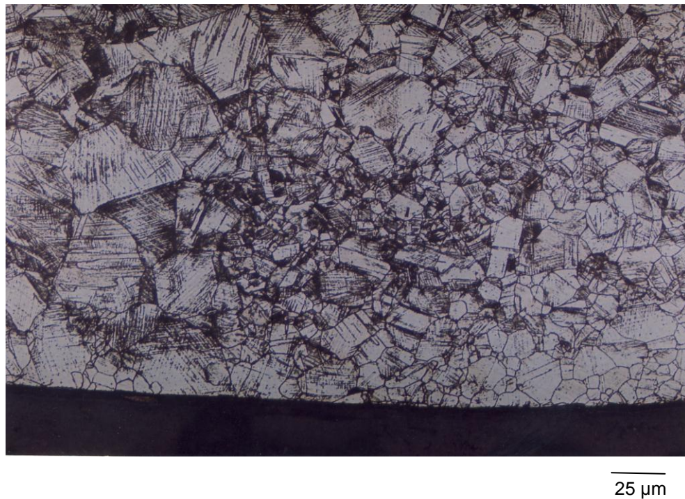
Gambar 10. SS 304 Nitrocarburizing 700 o C dengan pembesaran 100x
