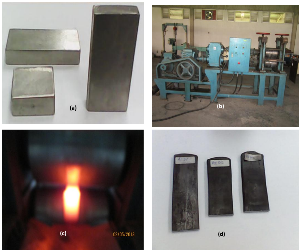
Gambar 1. Spesimen baja A2: (a) hasil cor foundry , (b) mesin rol, (c) prose rol panas dan (d) spesimen hasil rol panas.
