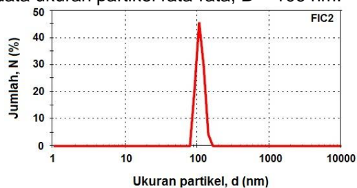
Gambar 1. Ukuran partikel dan distribusi ukuran partikel nano Fe pada cuplikan FIC2; ukuran partikel rata-rata D = 106 nm.
