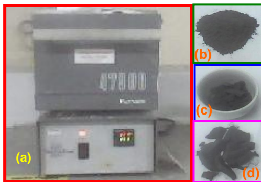
Gambar 1. Sintering serbuk A2 non standar untuk mentransformasi fasa; struktur besi body centered cubic (bcc) menjadi struktur face centered cubic (fcc) dengan metode powder metallurgy ; (a) tungku termolyne47000 (b) serbuk paduan besi a2 (c) precursor a2 dalam cawan keramik (d) precursor a2 quench dari 1100°C ke temperatur ruang.
