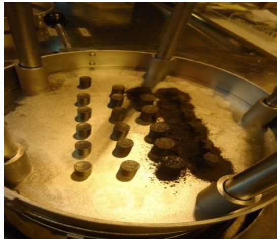
Gambar 4. Foto pelet sinter cermet UO 2 -Zr.
