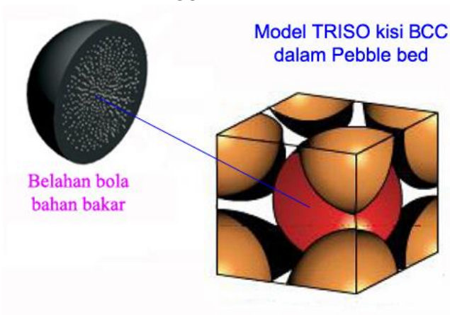
Gambar 4. Hasil pemodelan bentuk kisi BCC [14]
