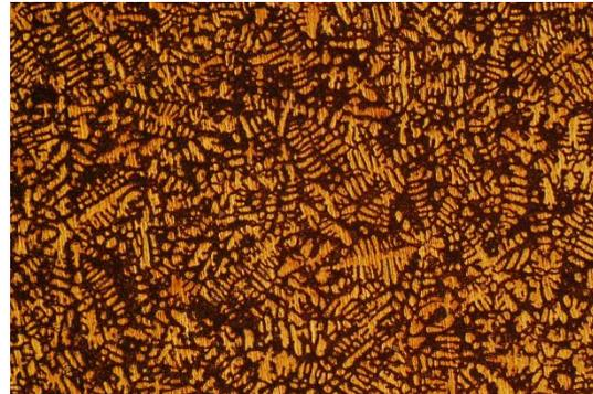
Gambar 1. Mikrostruktur paduan U-7Mo hasil proses peleburan
