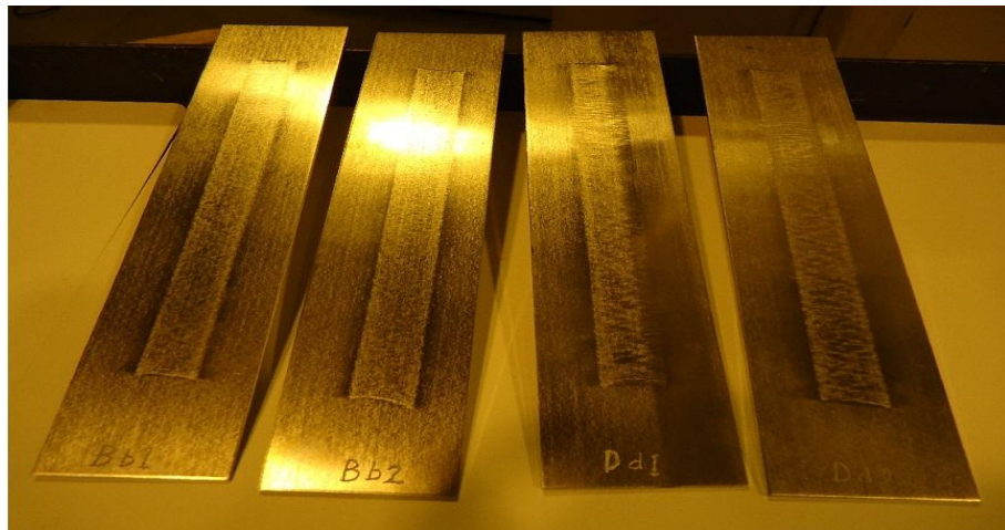
Gambar 3. Data pengamatan permukaan U-7Mo/Al-Si PEB Bb1–Bb2 dan Dd1–Dd2.
