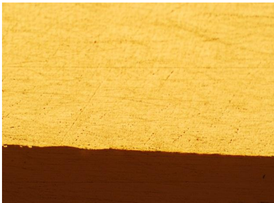
a. Perpaduan awal AlFeNiMg (warna terang) sebelum dilakukan uji korosi.
