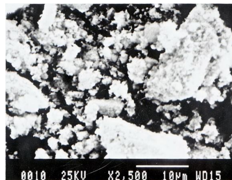
Gambar 6. Morfologi serbuk uranium oksida dari hasil pengendapan ADU pada pH = 7, t = 45 menit, T = 65 °C
