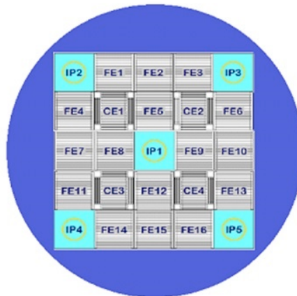
Gambar 2. Konfigurasi teras RRI-50 [2,3,6]
