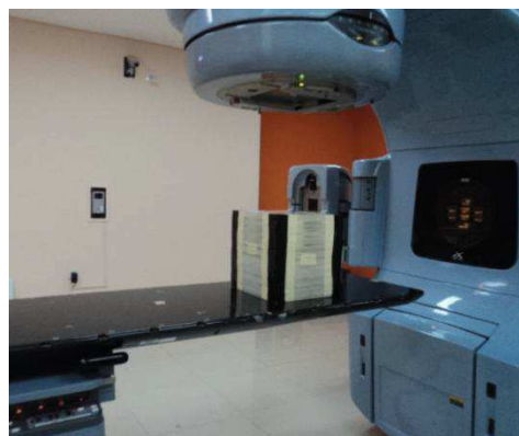
Gambar 3. Seting penyinaran fantom padat yang berisi foil indium pada titik isocenter dengan SSD 100 cm dan posisi gantri ke bawah.
