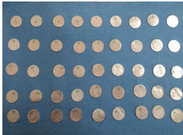
Gambar 1. Foil Indium diameter 1,4 cm dengan ketebalan 0.5 mm yang disisipkan pada fantom PMM dengan jarak antar foil 6 cm.
