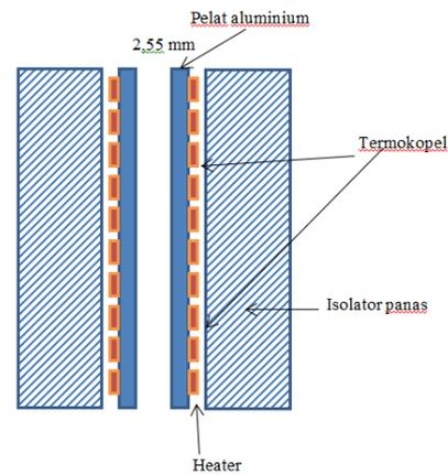
Gambar 2. Pemodelan batang uji Eksnal dengan heater
