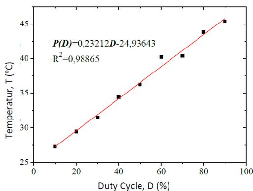
Gambar 8. Pengaruh *duty cycle* terhadap temperatur air.
