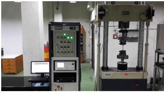
Gambar 5. Mesin uji dinamis 250 kN
