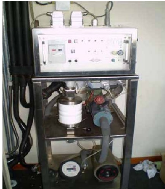
Gambar 1. Peralatan pompa hisap pengambilan sampel cerobong RSG GAS [11]
