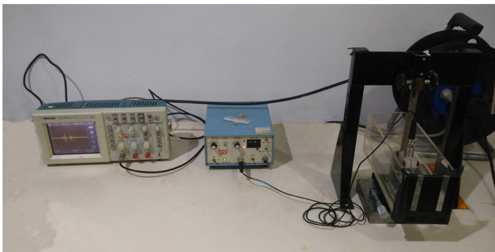
Gambar 1 Alat ultrasonic water immersion untuk visualisasi nugget las titik
