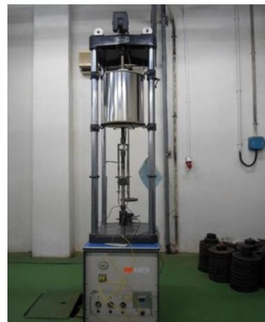
Gambar 4. Mesin uji *creep* (tampak depan) [9]
