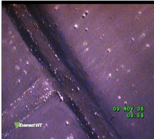
Gambar 3. Korosi sumuran pada bagian pengelasan dan badan bejana reaktor TRIGA2000 [9]
