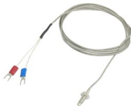
Gambar 2. Termokopel Tipe K yang digunakan pada FASSIP [6]
