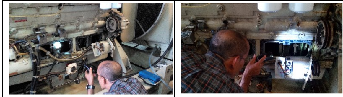
a). Pemeriksaan kebocoran pada cylinder head No. 1 Bagian Kiri
