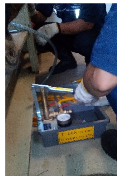
b). Pemberian tekanan oleh pressure test pump
