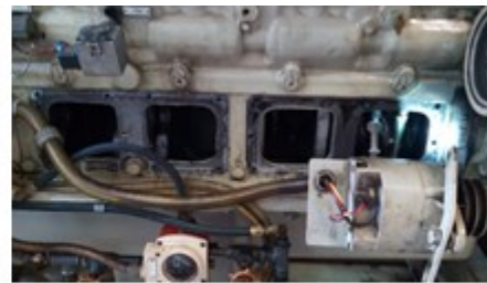
b). Tutup jendela Cylinder Head telah terbuka
