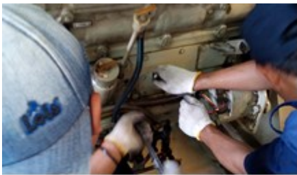
a). Pembukaan jendela Cylinder Head No. 1 Bagian Kiri
