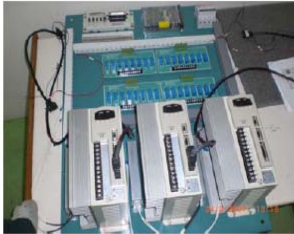
Gambar 7. Rangkaian servo drive yang siap dirakit untuk 3 motor servo
