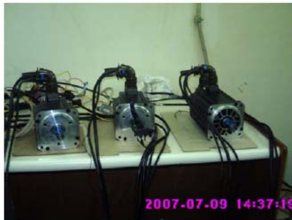
Gambar 8. Tiga motor servo yang siap dirakit untuk mesin frais konvensional
