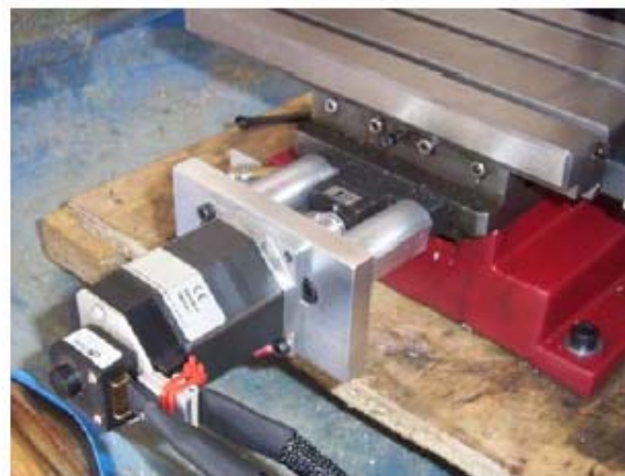
Gambar 9. Penggabungan motor servo dengan mesin frais sebagai load.
