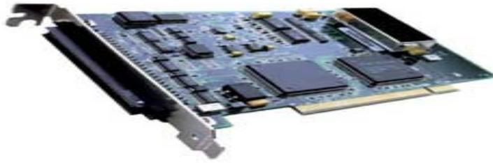
Gambar 10. Kartu Akuisisi Data standar *PCI Bus Slot PC*
