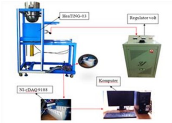
Gambar 5. Tata letak eksperimen pemanasan bundel uji semi-sphere
