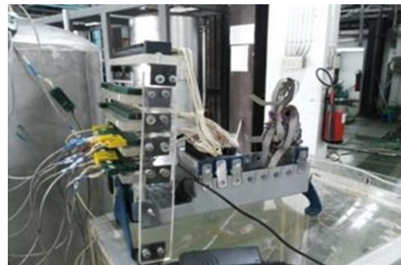
Gambar 4. Alat perekam data NI-CDAQ 9188 untuk mengukur temperatur termokopel
