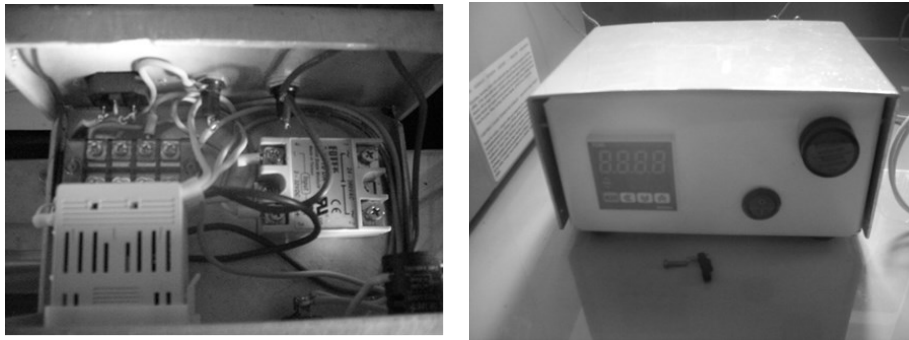
Gambar 5. Instalasi sistem pengendali temperatur
