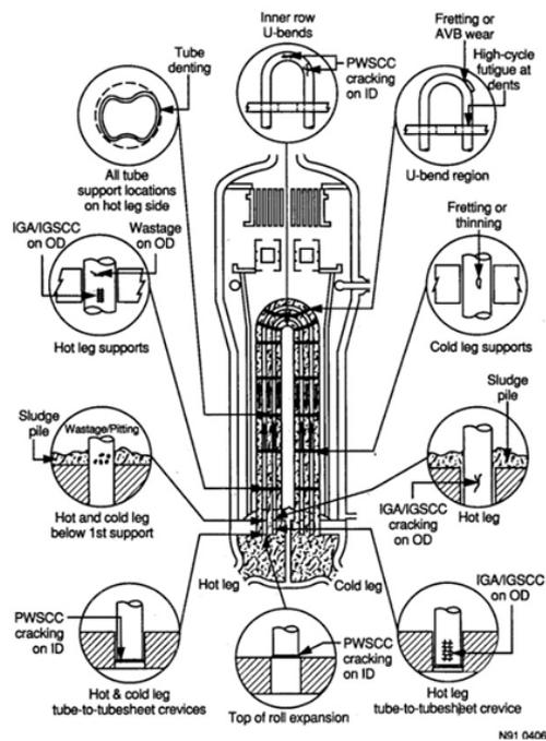
Gambar 2. Lokasi dan mekanisme degradasi dinding tabung pembangkit uap PWR tipe resirkulasi<sup>[1]</sup>
