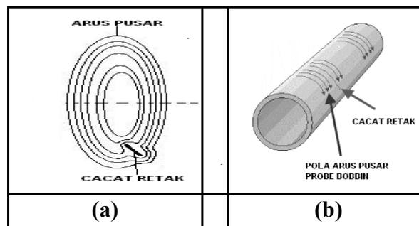
Gambar 9. (a) Retak memotong alur arus pusar, dan (b) retak tabung yang arahnya melingkar tidak dapat dideteksi *probe bobbin*<sup>(7)</sup>
