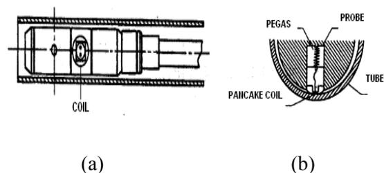
Gambar 6. (a) Probe MRPC di dalam tabung, dan (b) penampang lintang probe MRPC di dalam tabung yang mempunyai satu kumparan<sup>(3)</sup>
