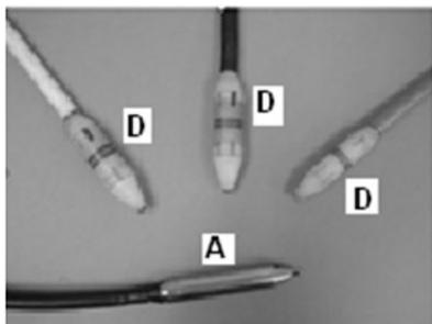
Gambar 5. Bentuk fisik *probe bobbin absolute* (A) dan *probe bobbin differential* (D)<sup>(3)</sup>
