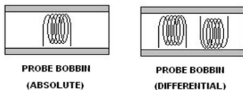
Gambar 4. Kumparan *Probe bobbin absolute* dan *probe bobbin differential*<sup>(3)</sup>
