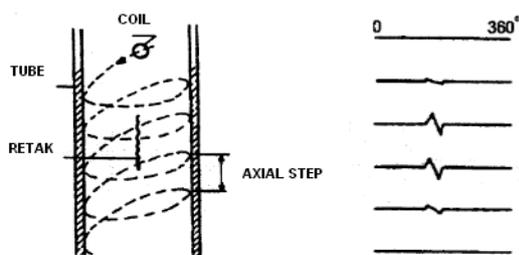
Gambar 10. Gerakan *scan probe MRPC* yang *helical* dan data rekaman<sup>(7,8)</sup>
