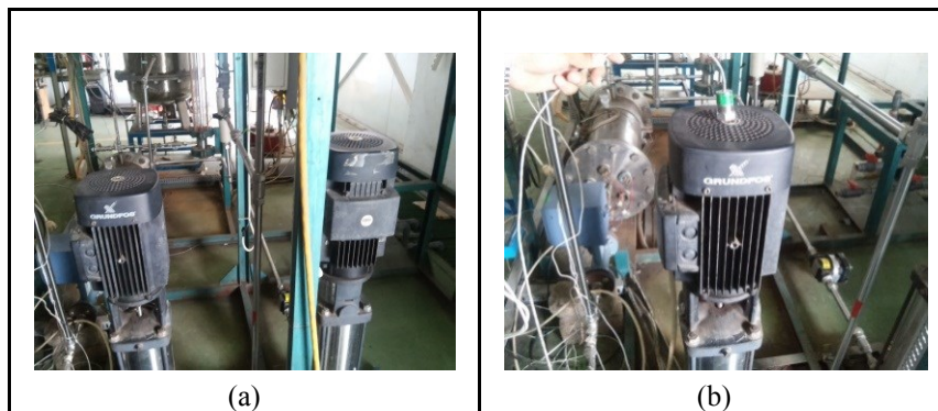
Gambar 3. (a) dua motor yang dibandingkan, (b) posisi uji vibrasi
