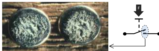
Gambar 2. Logam-kontak bagian-koneksi saklar [8] .
